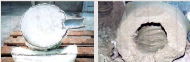
▲ プレロードモルタル T-1 ▲ 普通セメントモルタル
